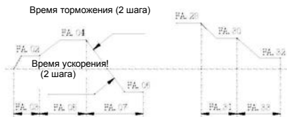
Рис. 6-24. Управление с использованием простого PLC
