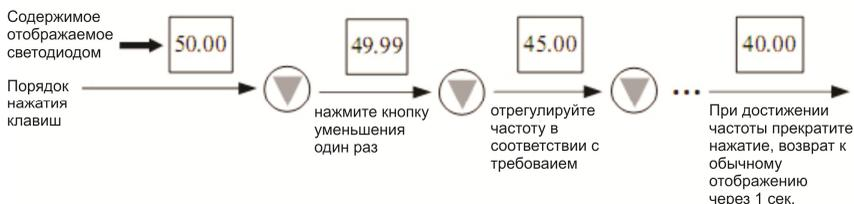
**Рис. 4-8 Пример регулировки установленной частоты**
