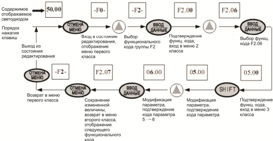
**Рис. 4-7** Пример установки и изменения параметра
