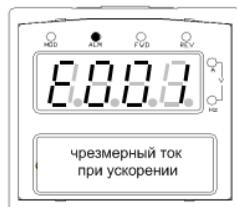
**Рис. 4-4 Сигнал неисправности**
